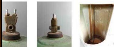
Se someten a pruebas de hermeticidad para comprobar la estanqueidad del asiento, sometiendo a toda aplicando una presión máxima de ensayo equivalente a una sobrepresión del 15% sobre la presión de servicio grabada en la válvula, a pruebas de resistencia térmica (a 60°C y hasta 70°C en casos especiales) y pruebas de resistencia térmica a bajas temperaturas (a -25°C y hasta -40°C en casos especiales).
