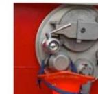
...era a la válvula, se abre y se bombea hasta líquido llegue al nivel del tapón. La entrada por la válvula de 5 efectos. Cuando el nivel de superior del orificio de salida se rompe la detener el bombeo.
