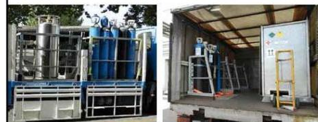
Tipos de transporte: transporte primario y secundario sin los vehículos de GLP en los que solo se permite el transporte de gas propano. Presentan diferentes formatos aunque los más usados normalmente son la botella de gas nominal es de 12,5 kg de butano, la UD-60 o el modelo actualizado K-6 de 6 kg o la UD-110, que contiene 11 kg de propano o en formato de 35 kg. También se consideran en este grupo los vehículos de transporte de gas licuado en botellones de 12 kg.
