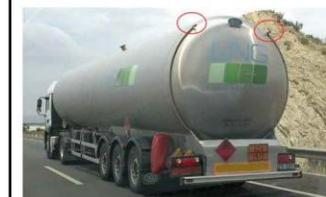
Fig. 25. Apagallamas o dispositivos de venteo en una cisterna para transporte primario aislada al vacío para GNL.
