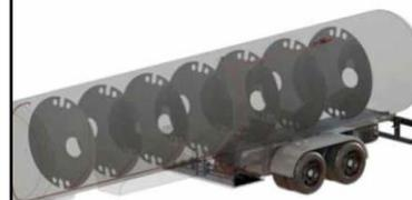
Fig. 23. Válvula de seguridad (en rojo) en una cisterna monocasco para el transporte de GNL. Foto cortesía del libro Gas Natural. El accidente de Zarzalico.
